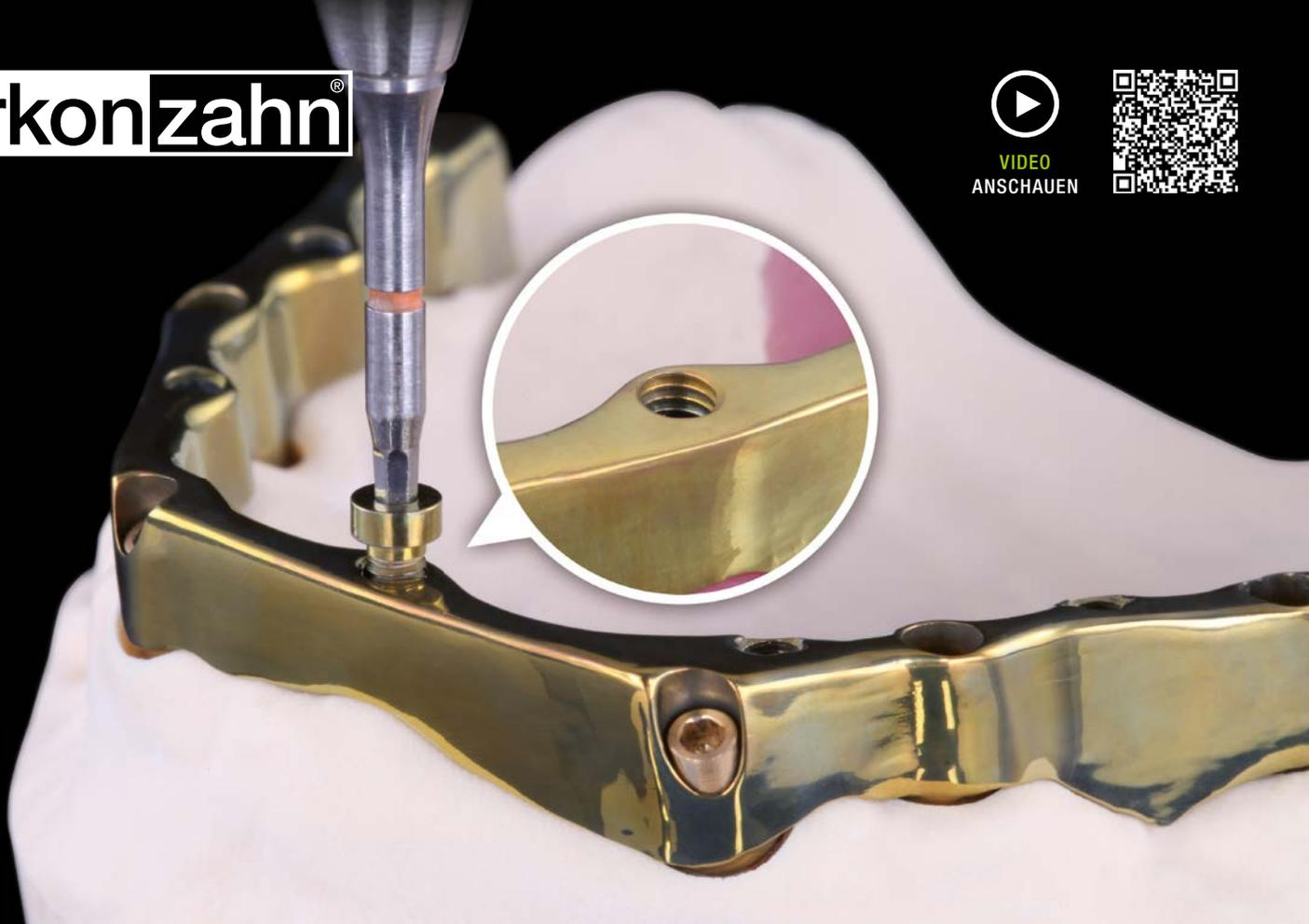
*Virtuell generierte und anschließend in den Steg gefräste Schraubengewinde zur Verschraubung der Sekundärstruktur auf dem goldfarbenen anodisierten Titansteg*
